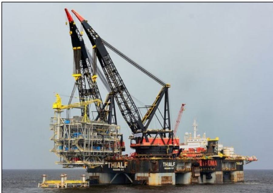
Figur 3 Det flydende installationsfartøj Thialf under installation af en offshore transformator-station. Thialf kan løfte op til 14.000 ton, herunder også gravitationsfundamenter til Bornholm.
